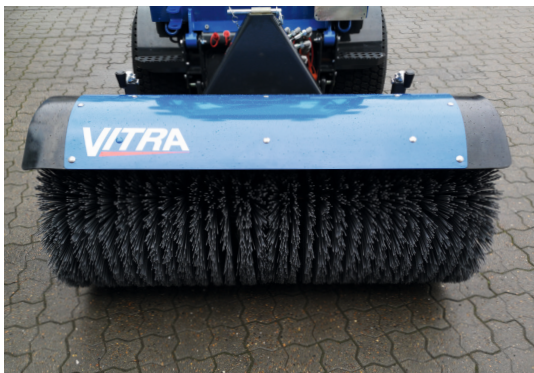
Der Aufbau sichert schnelle und einfache Austausch von Bürstenringe.
