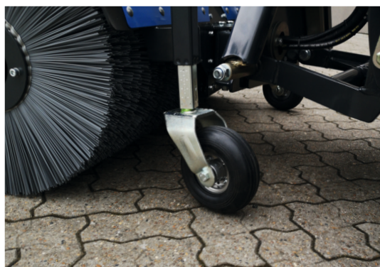
Solide Stützräder für optimaler Kehrergebnis mit minimaler Bürstenverschleiß.
